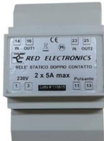
Dispositivo elettronico di commutazione di carichi resistivi a doppio contatto di uscita, con portata massima di 5A per contatto.
