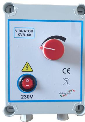
Questo driver è stato progettato per il controllo e la regolazione dell'ampiezza delle vibrazioni nei vibroalimentatori elettromagnetici industriali. E' in grado di pilotare un carico massimo di 3,5A a 230V ed è dotato di un adeguato filtro antdisturbo.
