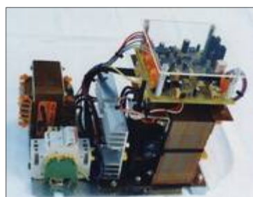
Alimentatori lineari raddrizzati, filtrati e/o Stabilizzati monofase e trifase
